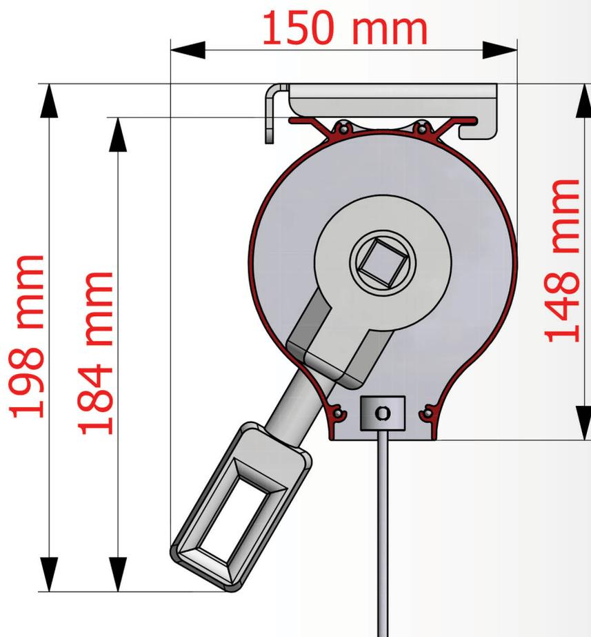
**Posa Soffitto con Argano a Snodo Cardano:**
